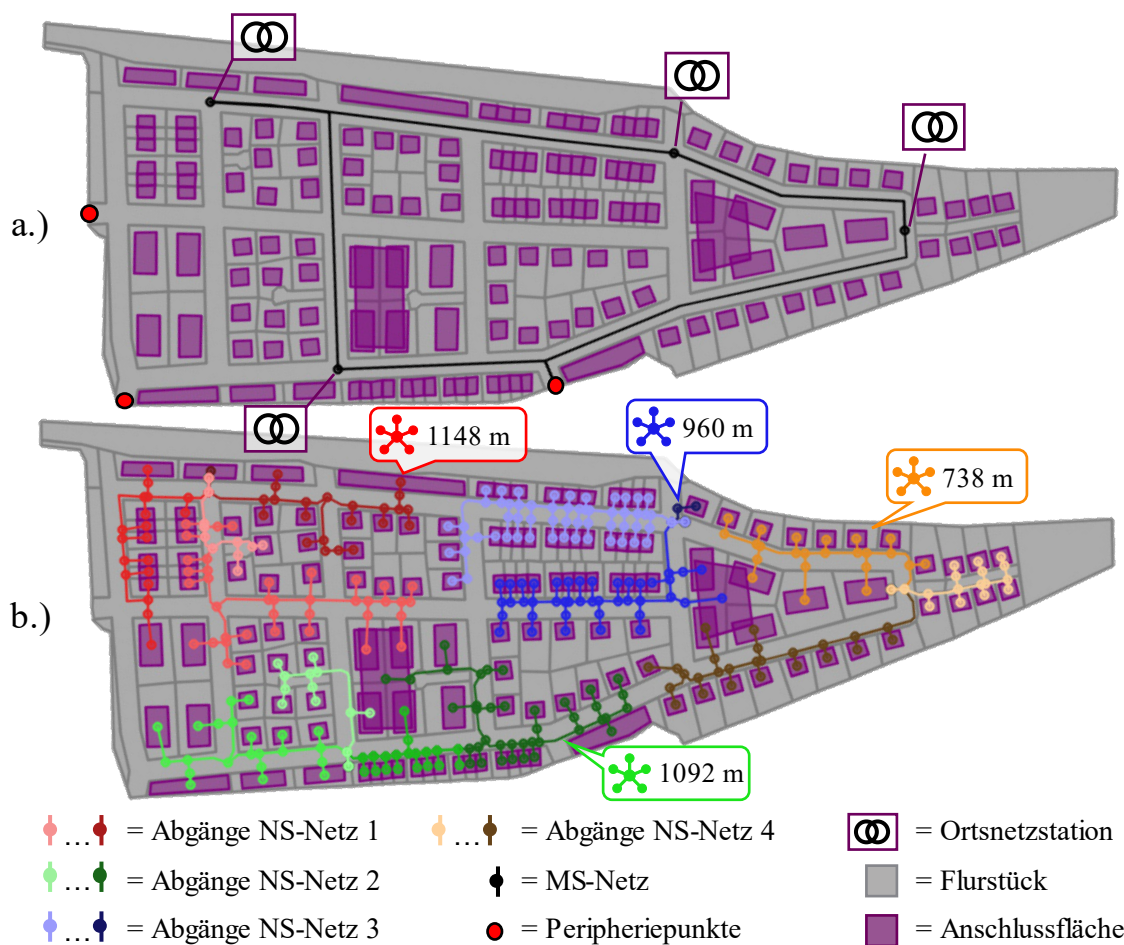
Abbildung 10-23: Periphere MS-Einbindung (a.) und finale NS-Netzstrukturen (b.) für Quartiersszenario SR Mischgebiet und Elektromobilitätsszenario OS auf Basis der Neu-Planung
