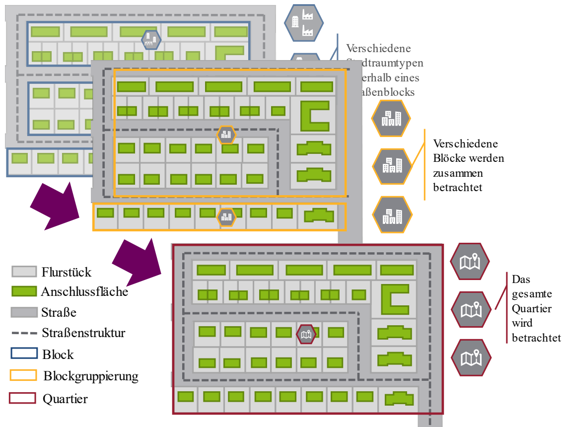
Abbildung 4-10: Darstellung der Optimierungsebenen „Blockgruppierung“ und „Quartier“ in einem schematischen Quartier
