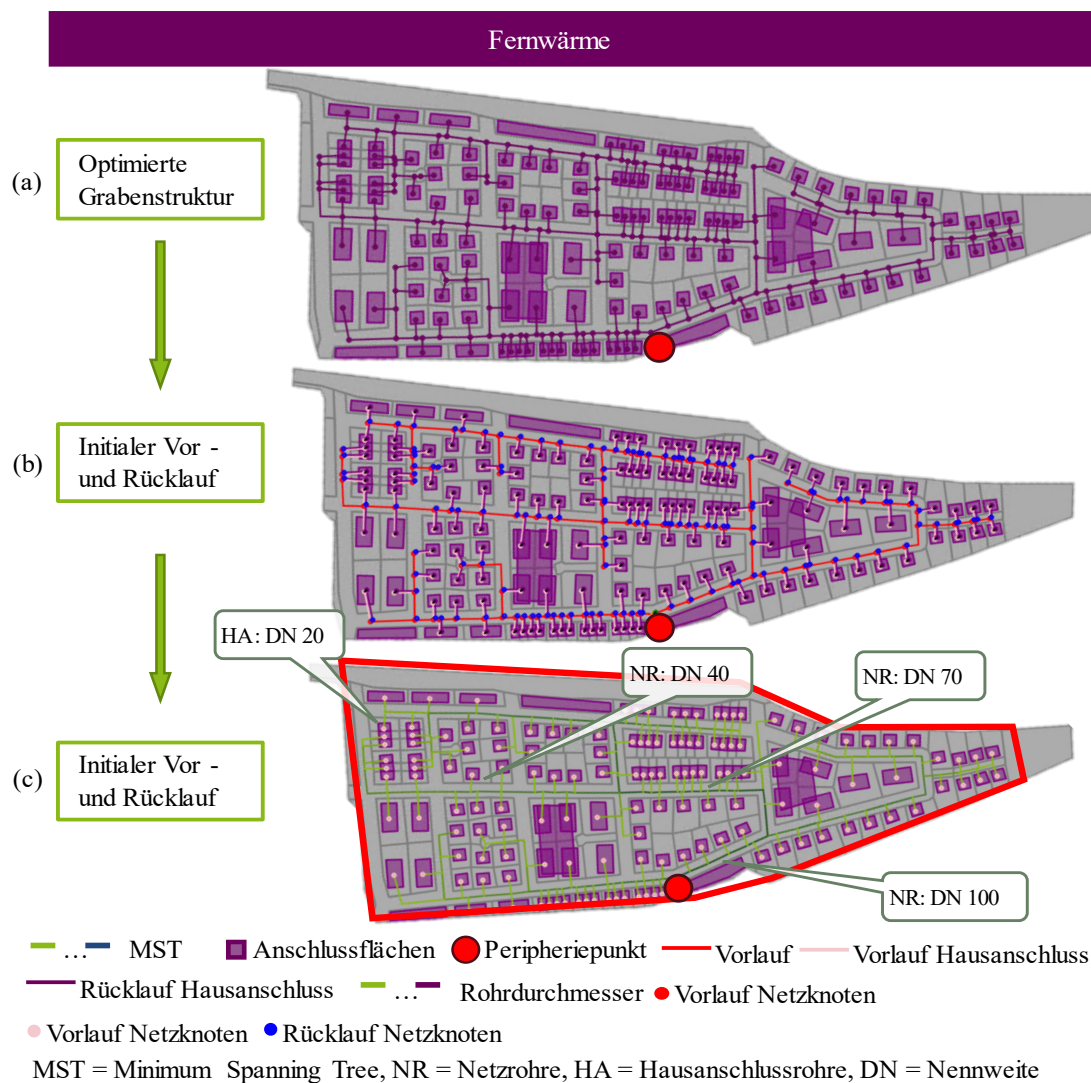
Abbildung 10-16: Wärmenetzauslegung Optimierungsebene „Quartier“
