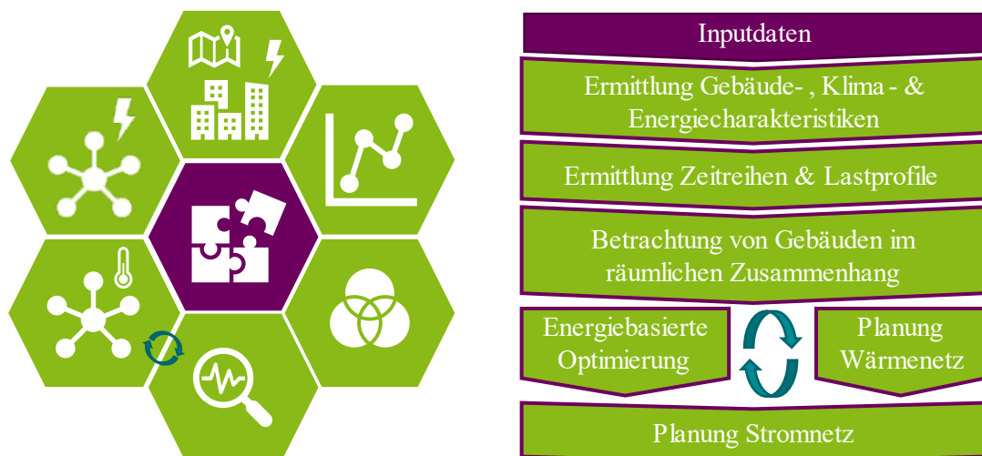
Abbildung 1-3: Ablauf der automatisierten sektorenübergreifenden Planung
